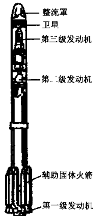
图 3.6 多级火箭示意图
